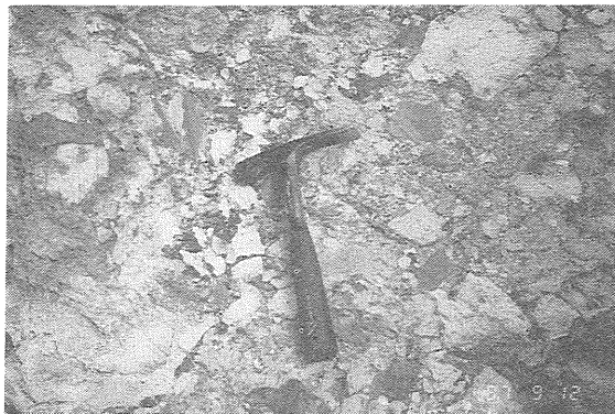
第10図 Chinchillas 鉱山の変質帯にみられる火道角礫岩状の岩石.
