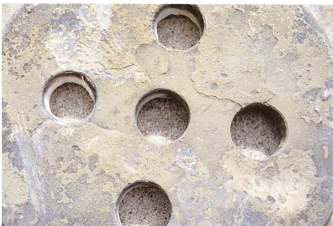
↑写真6 ブロードランツ22号井 バックプレッシャープレートに付着した含金(4.5%Au)黄銅鉱(18.8%Cu)沈殿物。 穴の直径は34mm。
