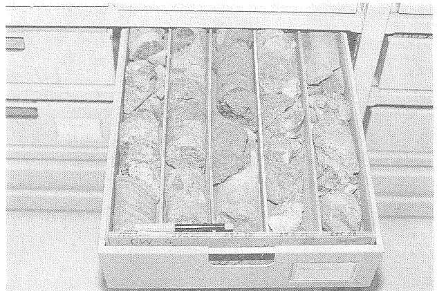
写真8 電動式スタックランナーの金属製モロブタ内へのコア収納状況 (豊肥 DW-4号井) 現場から搬入されたコアは特製ベニヤ箱に移し替えられた後に このモロブタ (40×60×13cm 大) 内に収納される (写真の場合モロブタ内に2段重ねになっている)。
