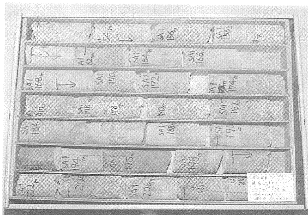
写真9 収納スペース節約のために 2 mあたり 10cm (5%) に 縮減されて モロブタ内に 入れられたコア試料(薩南 S A- 1号井).
