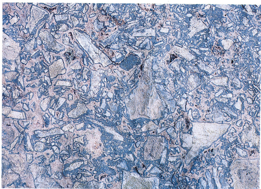
写真5 角礫スカルン① 柘榴石型1)：最も普遍的なもの。基質が柘榴石、緑泥石化閃緑岩角礫を磁鉄鉱（黒色）が緑どり更に柘榴石が埋める（左右50cm）。
