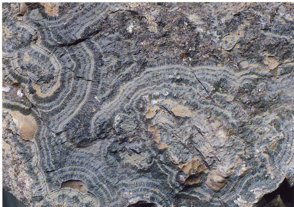
写真3 李地鉱床。これは代表的なスカム鉱物の一つであるヘデン輝石が年輪状に結晶し、その間を閃亜鉛鉱（黒褐色）などが埋めるために名付けられた（栃洞鉱石 -290mL, 5乙 左右22cm）。
