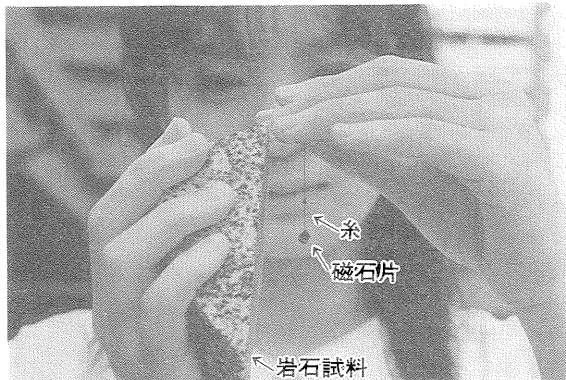
写真13 酸化型/還元型花崗岩を区別する簡便な方法。
