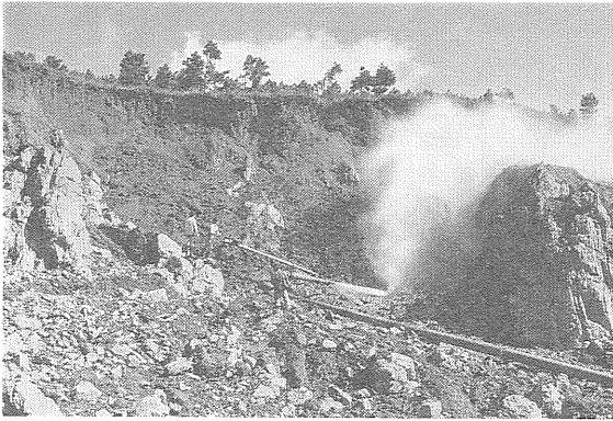
写真11 老廠鉱床地表部での高圧水による砂錫の採掘。
