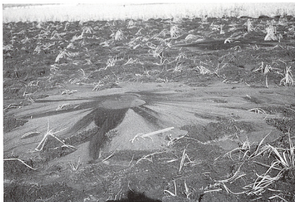
↑写真2 九十九里平野の海岸付近の水田に形成された噴砂丘（旭市椎名内 12月18日撮影）
