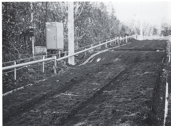
↑ 写真16 大島南東部にできた割れ目と伸縮計(本文遠藤ほかを参照)。割れ目の方向は北西—南東で手前側が55cm落ちている。道路には降下スコリア(B火口起源)が約10cm積もっている(1月10日撮影)。
