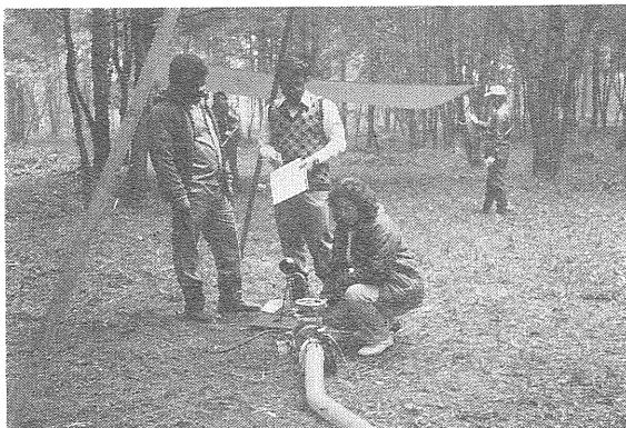
写真6 揚水の野外実習を行う地下水コース研修員。 筑波研究センターには専用の試験井があって、毎年の実習に欠かせない存在となっています。
