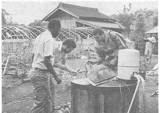
写真3 浅井戸を利用した地下水調査 (茨城県常北町にて) 地下水位を測定している 左よりスワジランドのリオさん ブラジルのカルロスさん エジプトのアデルさん
