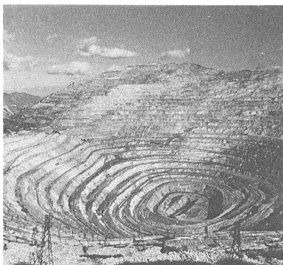
写真 I-2 斑岩銅鉛石を採掘する アメリカ合州国 ユタ州 ビンガム鉱山 露天掘り採鉱場
