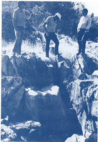
口絵7 カルストを埋める砂金、砂金の特異な産状として 石灰岩地帯の割目や凹みを埋めるものがあった、1853—70年間に手びろいで採掘された、砂金は粗粒 1854年には2.3kgの金塊が出るなど ナゲットが多く 世界的にみて最も濃集した砂金の一つであったと言われている。筆者は地下には洞穴があって金粒でつまっている所があらうから 物探をかけることを主張したが 案内者には一笑に付された。
