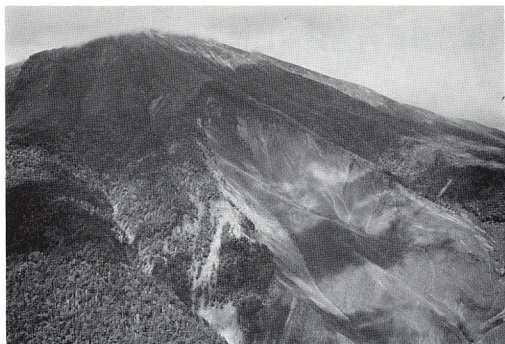
写真2 御岳八合目の崩壊地付近。伝上川源頭の尾根が崩れ落ち、馬蹄形の凹部（右から2番目の新しい沢）ができた。（9月17日撮影）
