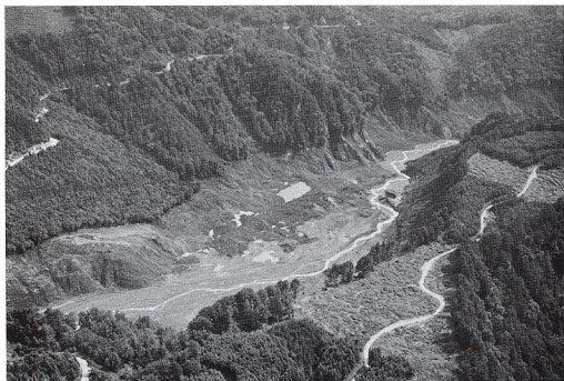
写真6 岩屑流の主流が通過した濁川温泉付近。崩壊地から6.5km下流の濁川温泉付近を通過した岩屑流の厚さは70—80m。一家4人が行方不明となった温泉旅館の跡には 厚い岩屑流堆積物と流れ山が残された。(9月21日撮影)
