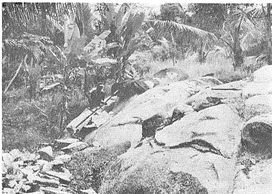
写真5-3 バンカ島の花崗岩採石風景。 露頭の上で火を焚いて岩石を破壊する。
