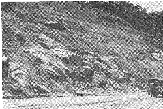
写真2-7 著しく風化の進んだ花崗岩露頭。 イポー北西のトンネル工事現場で
