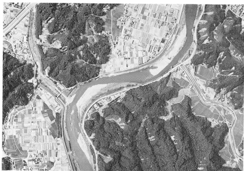
写真2 益田市飯田・角井付近の山崩れ・土石流 地質は三郡変成岩とそれを不整合に覆う久利・川合層及び郡野津層からなる（アジア航測撮影）
