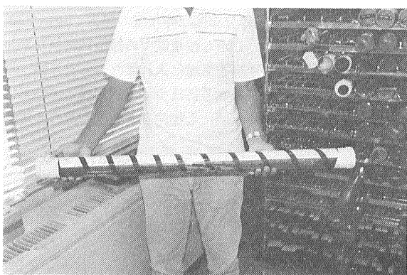
写真16 庁舎の実験室に持ち帰ったボーリング試料 試料のまわりの黒いテープは圧密開放による膨張防止用 白いテープはインナーチューブの接着用とキャップ止め用
