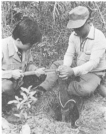
写真18 寝覚の床対岸の水井戸における水の採取 2口注射器の使い方には熟練を要するが2人でやれば容易である。右側は井戸の所有者 井上登氏
