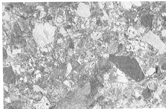
写真10 磁硫鉄鉱 黄銅鉄鉱石片や二重変質礫を含む角礫岩。左右 40cm。
