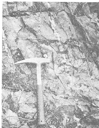
写真28 漂塘鉄床地表部の平行な石英細脈群. 多量の錫石が含まれる.
