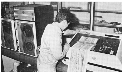
写真2 新型サイド・スキャン・ ソナー装置 右：マスターユニット 左：磁気テープ装置
