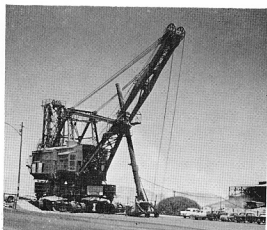
写真5 世界最大の電気シャベル。鉱石はかつてこの巨大なシャベルでトラックに積み込まれたが現在では小回りがきく小型シャベルに変更されチュキカマタの巨大さを示すシンボルとして、鉱山事務所前の広場に展示されている。
