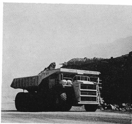
写真6 200トン積みトラック。鉱石の運搬はすべてトラック(200トンと120積み)が用いられている。
