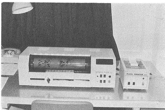
写真 3-1 デジタル面積測定器(プラニ Z-2)測定図形の色は白または黒色で走査線の密度は5 Line/mmである。
