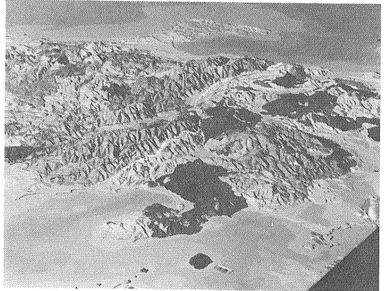
写真2 本州中央部の地質模型 糸魚川—静岡構造線(点灯中)をはさんで 西方では 伊那谷断層・阿寺断層などの活断層が密集し 東方では 第四紀の成層火山が配列します。起伏は実際の約3倍に誇張されており 富士山の高さは約3.5cm。
