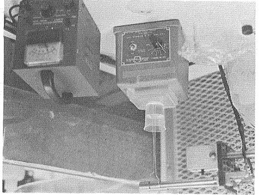
図37 鉛抽出法の最後の段階の Pb-plating 法。 小ピーカーの白金電極に鉛が回収される。
