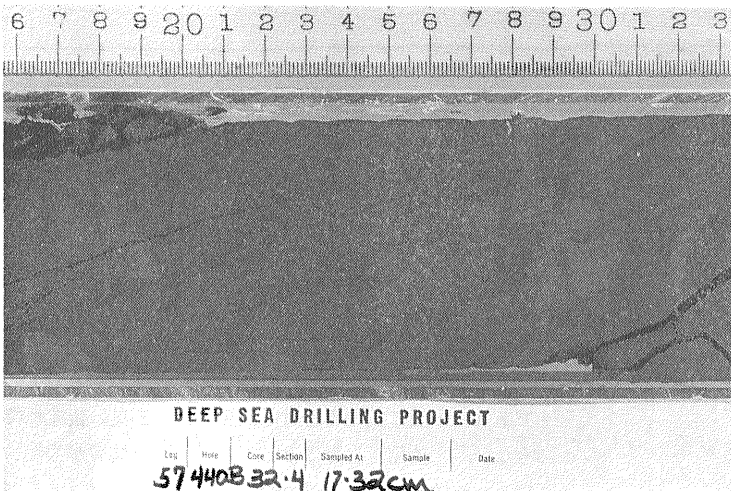
写真3 陸側海溝斜面上部のベンチでの掘削で得られたコア一試料 幾つかの小断層が発達している
