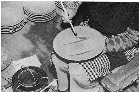
⑦ 絵付け 素焼された素地に益子独特の釉薬で絵付けする (塚本製陶)
