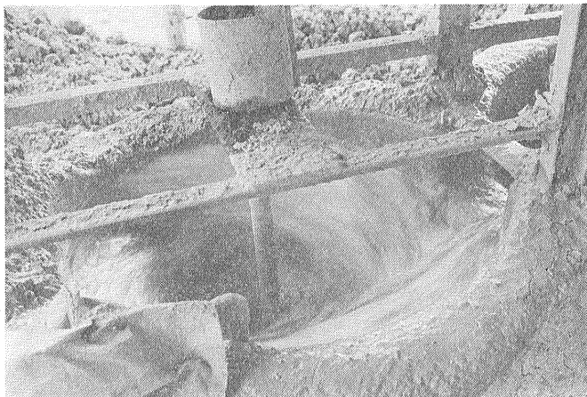
①原土に多量の水を加えて攪拌して懸濁液を作る。懸濁液は篩を通して沈殿槽に導かれる。(陶磁器協同組合)
