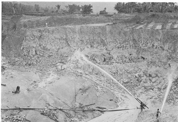
① 花崗岩の風化と浸蝕により生じた第四紀の堆積物中に黒砂鉱床としてふくまれる錫石やモナザイトにコンプレッサーから高压で放水し、錫物を洗い出す作業
