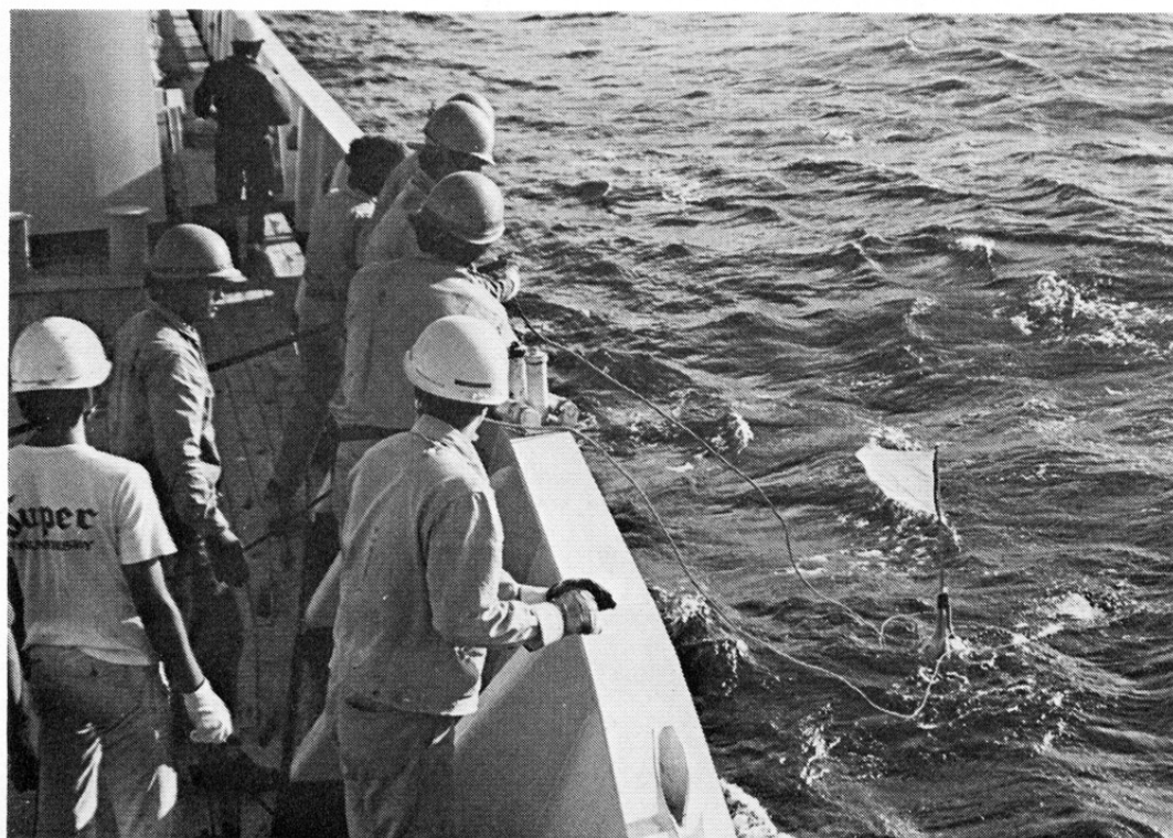
④ 海面に浮上 漂流中のフリーフォールサンプラーの揚収（前部甲板右舷）
