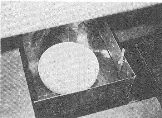
写真7 ノッチの水面高測定水槽と水位計フロート
