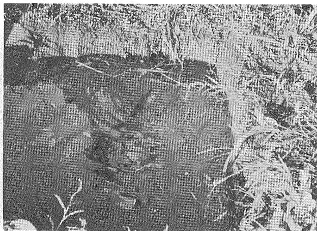
② 泥炭地の人工ガス徴 泥炭地に4角形の穴を掘って地下水を溜め そのなかへスパイラルで孔を掘ると遊離ガスが自噴してくることがある
