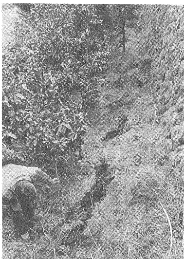
写真18 みかん畑の断層。 大きく開口している引張り割れ目が剪断割れ目につながったジグザク状のパターンをしている (Loc. 17).
