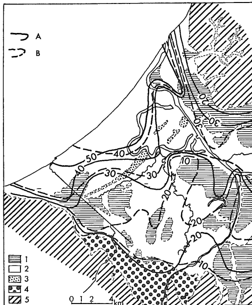
第5図 石狩平野の軟弱地盤基底等深線図 A: 下部砂礫基底 B: 下部泥層層基底 1: 泥炭 2: 沖積地 3: 紅葉山砂丘 4: 扇状地 5: 先第四系
