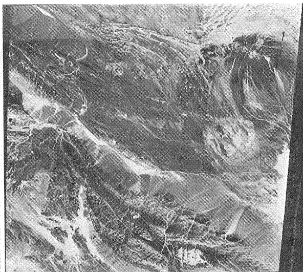
第4図 ERTS/LANDSAT 映像から各種の補正をコンピューターで行なって 最も正確な情報が写されるような試みもされている イランの例 基盤構造 断層 火成岩体などが完成された地質図のように映し出されている
