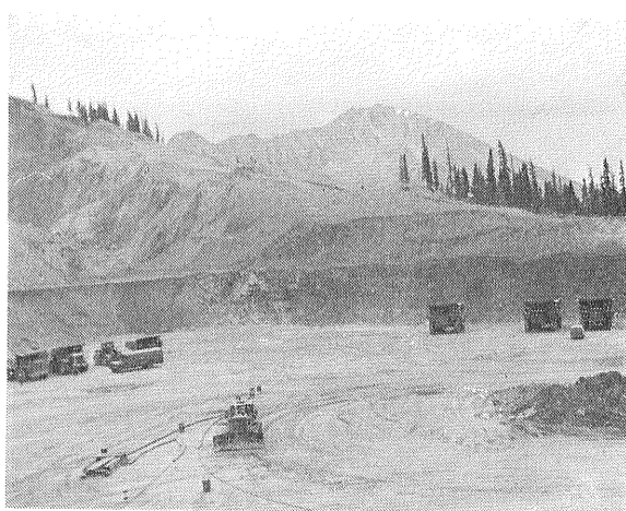
写真6 右側に3台並んでいるのが Climax 鉱山で用いている120トンダンプ・トラック。手前の自動車や左方のバスと大きさを比べてほしい。9月初めたが遠景の山に万年雪が見られる。
