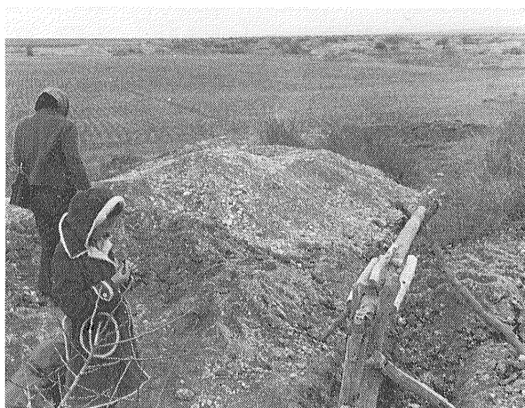
写真⑤ 坑口の地表に組まれた滑車 掘られた海泡石はバケツに入れて巻き上げられる。採掘する人もこれを利用して坑内に上り降りする。(ネムリイキヨイ)
