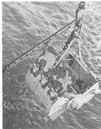
写真② 天秤式起動装置使用のオケヤン-70型採泥器
