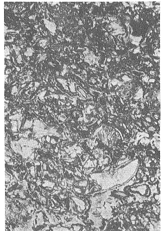
第7図 鏡下のハイアロクラスタイト(徳島県佐那河内村産)こまかな火山ガラス破片の集合である[平行ニコル ×20]
