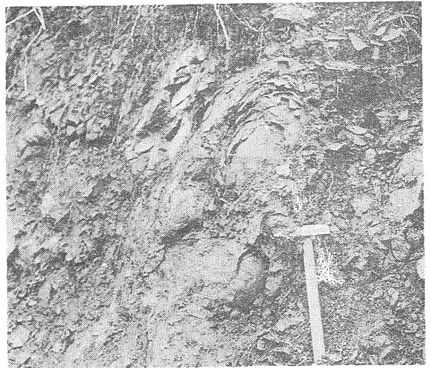
写真⑧ 変質玄武岩の玉ネギ構造
