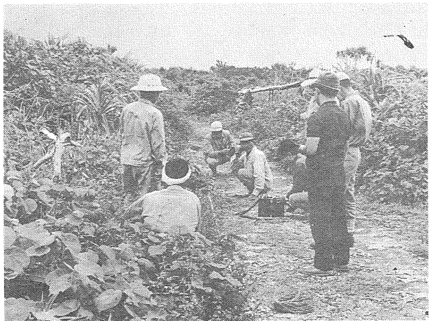
写真19 黒島東部のトラバーチン化した石灰岩の上での電気探査
