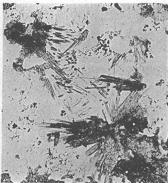
写真① 多色性を示す電気石 20倍 偏光板オープン 大分県大野郡尾平鉱山
