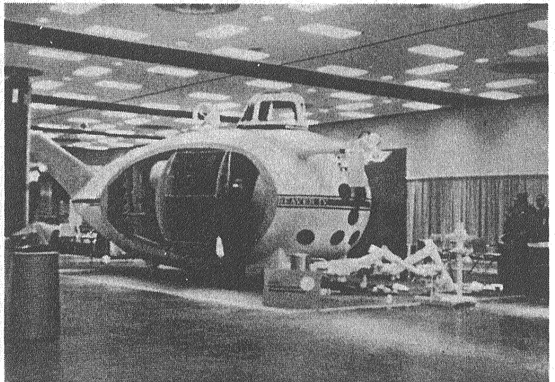
写真12 ビーバー号はおもに海底パイプライン作業に関連して用いられる(水深2,000フィート程度) [North American Rock well 社の展示用のもの]
