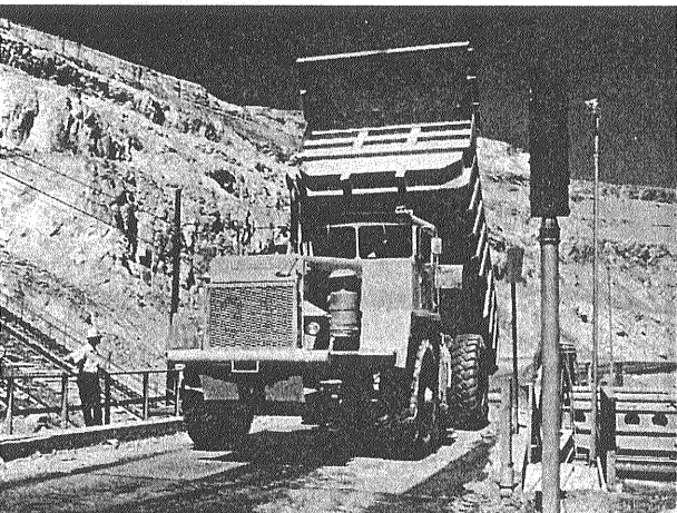
鉱石運搬用のスキップに落ちるところ。ピットが深くなるとインクラインで捲き上げる方が経済的である。
