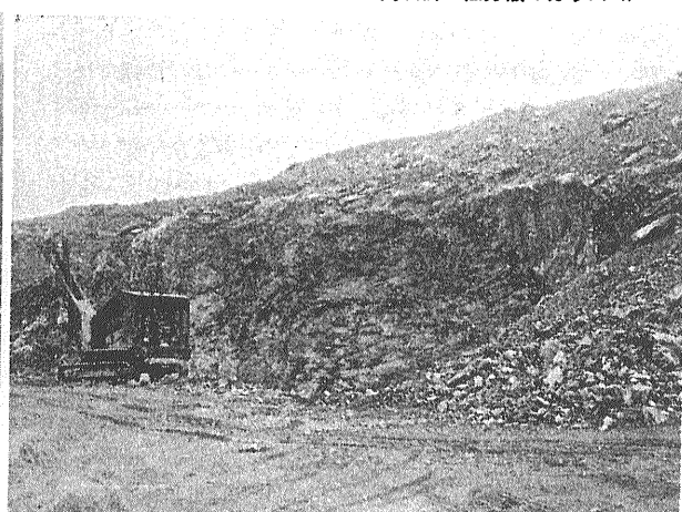
バストネサイト(Bastnaesite)採掘場 月産2,000~2,500トンの露天堀で第3図の断面図に見られるように大部分がバストネサイト鉱石ハッパでくづれた部分はそのまますべてパワースショベルでダンプトラックへ。
