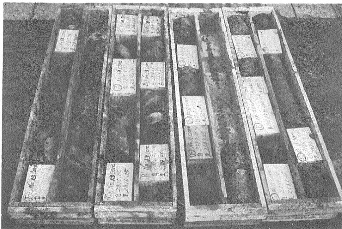
第2図 採取したコア 試験・測定種目により F・B・C・P等の記号を付してサンプリング済みの位置にボードが入れている。
