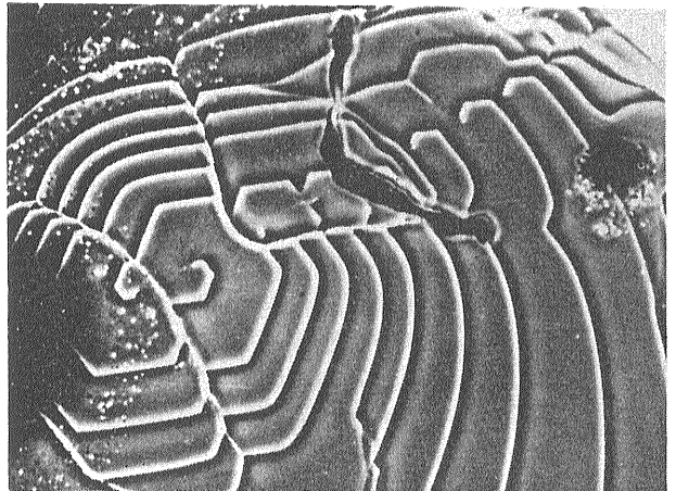
炭化珪素の結晶の (0001) 面上の渦巻 位相差顕微鏡 ×170
