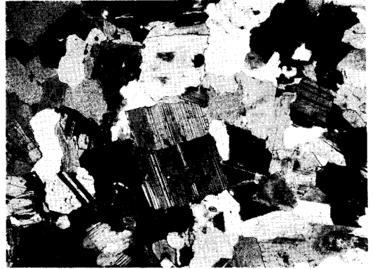
第6図 花崗岩の顕微鏡写真 この写真は偏光顕微鏡でとったため鉱物に明暗があるが実は大半が無色鉱物である 無色鉱物相互の容量比は花崗岩の分類に最も重要である
