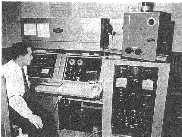
直読式分光分析装置 コンパクトアトムカウンター 岩石鉱物分析用に設計され 40本のフォトマルをそなえている 岩石主成分を含む約30元素の定量ができ スペクトル線強度はデジタルに表示すると同時にタイプで印字される (地質調査所 地球化学課)
