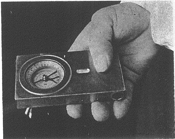
⑤普通のクリノメーターで方位角をはかる 長辺を目標にむけて 腰だめではかる
