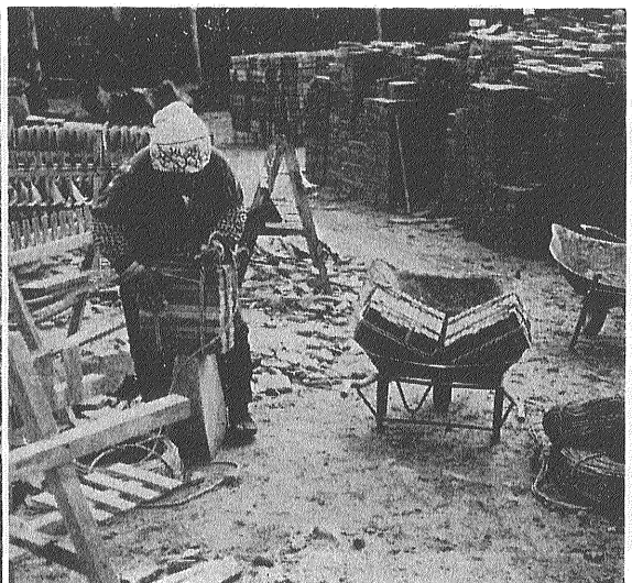
写真11 乾燥した抗火石板石の荷造り作業 天城では 12枚1組 新島では10枚1組となっている (天城山にて)
