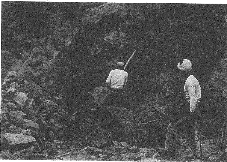
写真4 抗火石の採掘 ツルハシのみで掘り出す。中央の石塊は加工できる大きさ。左方の石塊は加工するに小さい排石（新島にて）
