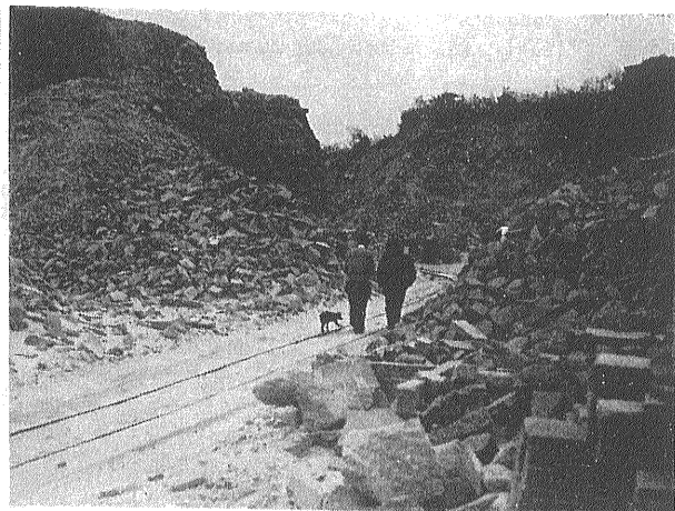
写真7 抗火石の採掘場 手前の左右が切断加工の際の 屑石の山 右後方のかげが現工場 (新島にて)
