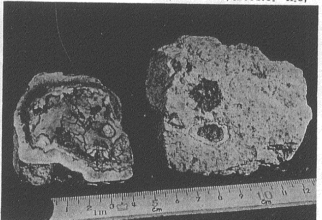
含ベリリウム凝灰岩(右)とほたる石礫(左)(ユタ州 Spor Mountain地区産)凝灰岩中の点線部はほたる石で その周縁部はとくに BeO の含有が高い ほたる石の礫(右)中央部はほたる石の紫色を呈し 灰黒の細脈は蛋白石脈 周縁の白色リング部はとくに BeO 分が高い
